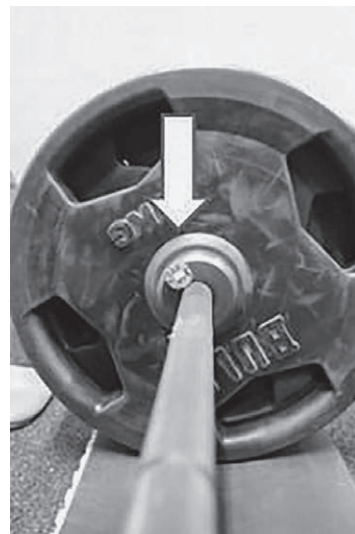
図4 加速度センサーを取り付けたバーベルシャフトのカラーの部分に直接貼り付けた（↓）。
