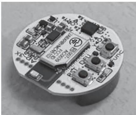
図2 三軸加速度センサー（AP-6X Braveridge Co. Ltd）
