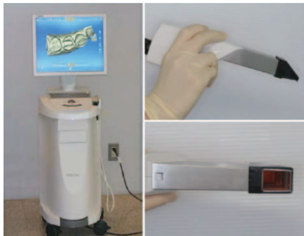
図 2 光学印象用の口腔内スキャナー (CEREC Bluecam)
